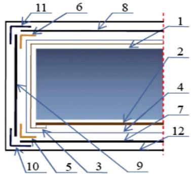
1. 钢卷 2. 内芯纸板 3. 防锈包装纸 4. 普通工业膜 5. 内纸护角 6. 外纸护角 7. 内周钢护板 8. 外周钢护板
