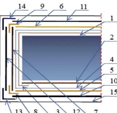
1. 钢卷 2. 内芯纸板 3. 防锈包装纸 4. 普通工业膜 5. 内周瓦楞纸护板 6. 外周瓦楞纸护板 7. 端部瓦楞纸护板 8. 内纸护角 9. 外纸护角 10. 内周钢护板 11. 外周钢护板 12. 端部塑料护板 13. 内钢护角 14. 外钢护角 15. 径向钢捆带
